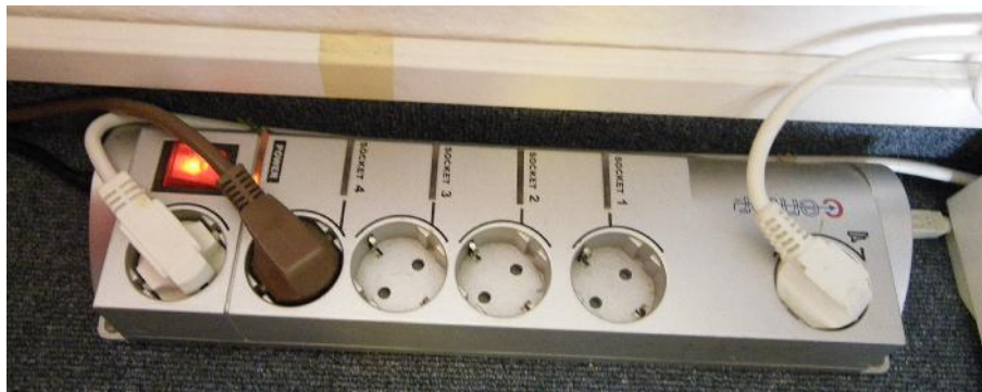
Abbildung 5: USB-Steckdosenleiste - der braune Stecker ist für die LEDs
