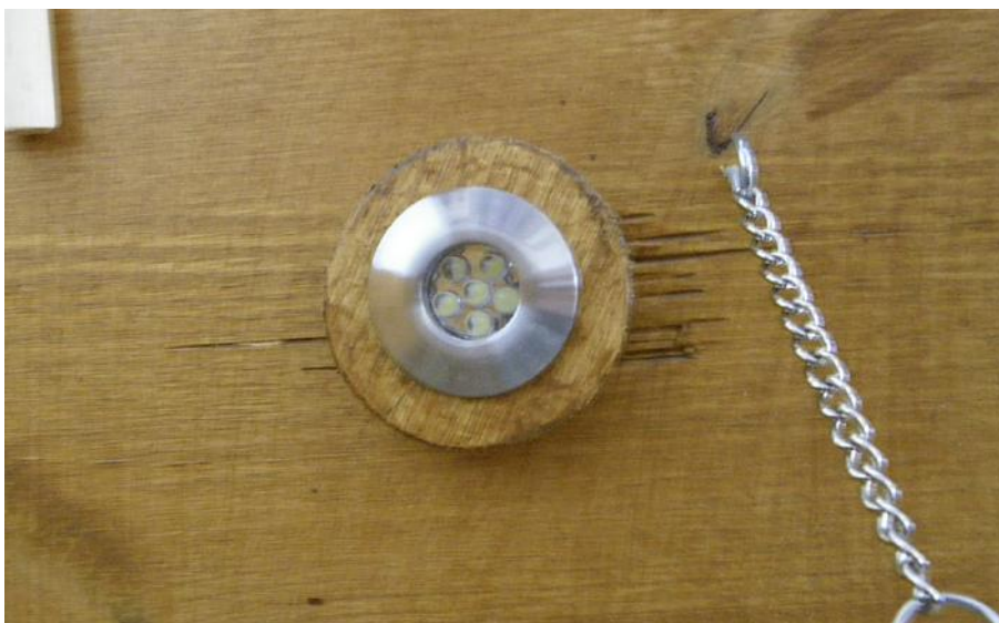
Abbildung 4: Einer von neun LED-Spots in einem Holzkreis
